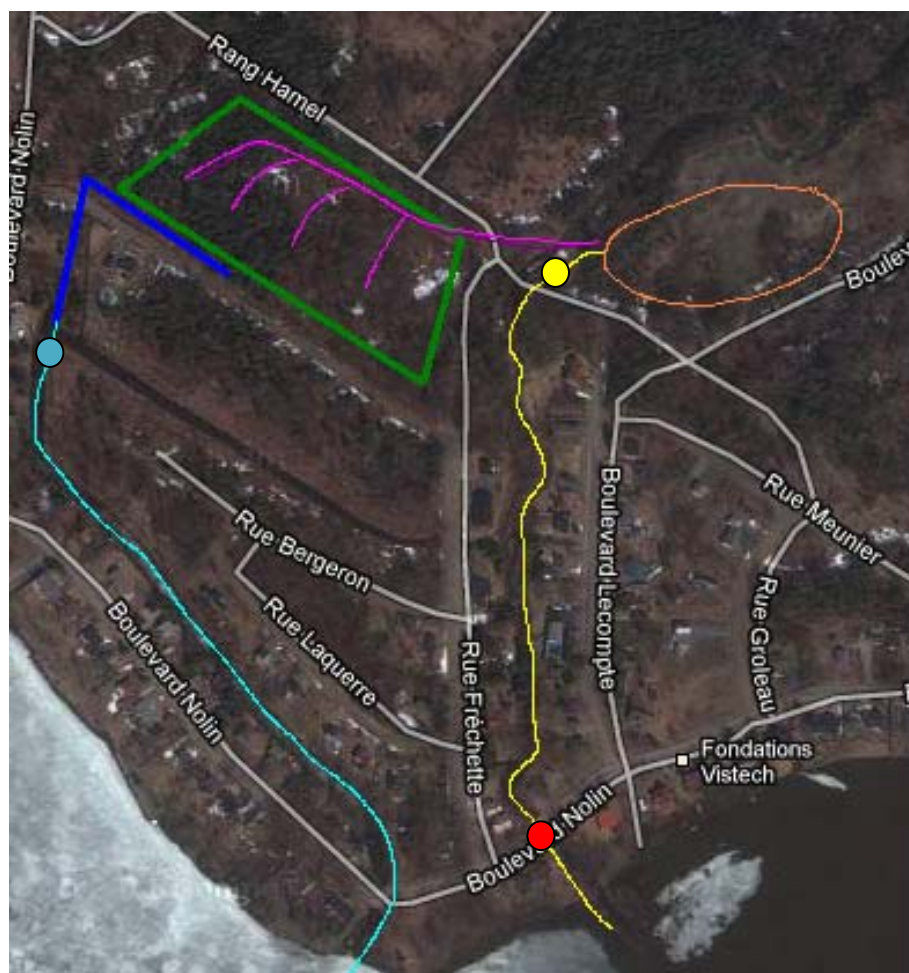
FIGURE 1 : LOCALISATION DES STATIONS D'ÉCHANTILLONNAGE, DU BASSIN DE DÉCANTATION ET DE LA ZONE FILTRATION EN MILIEU NATUREL
